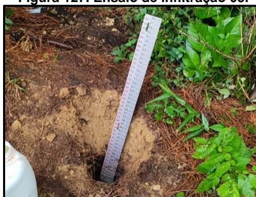
Figura 127. Ensaio de infiltração 05.
