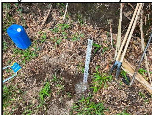
Figura 120. Ensaio de infiltração 02.
