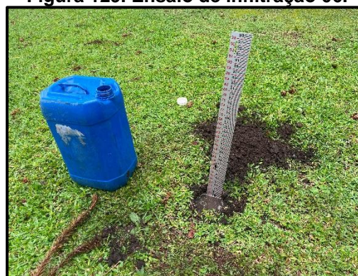
Figura 129. Ensaio de infiltração 06.
