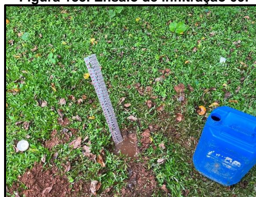
Figura 135. Ensaio de infiltração 09.
