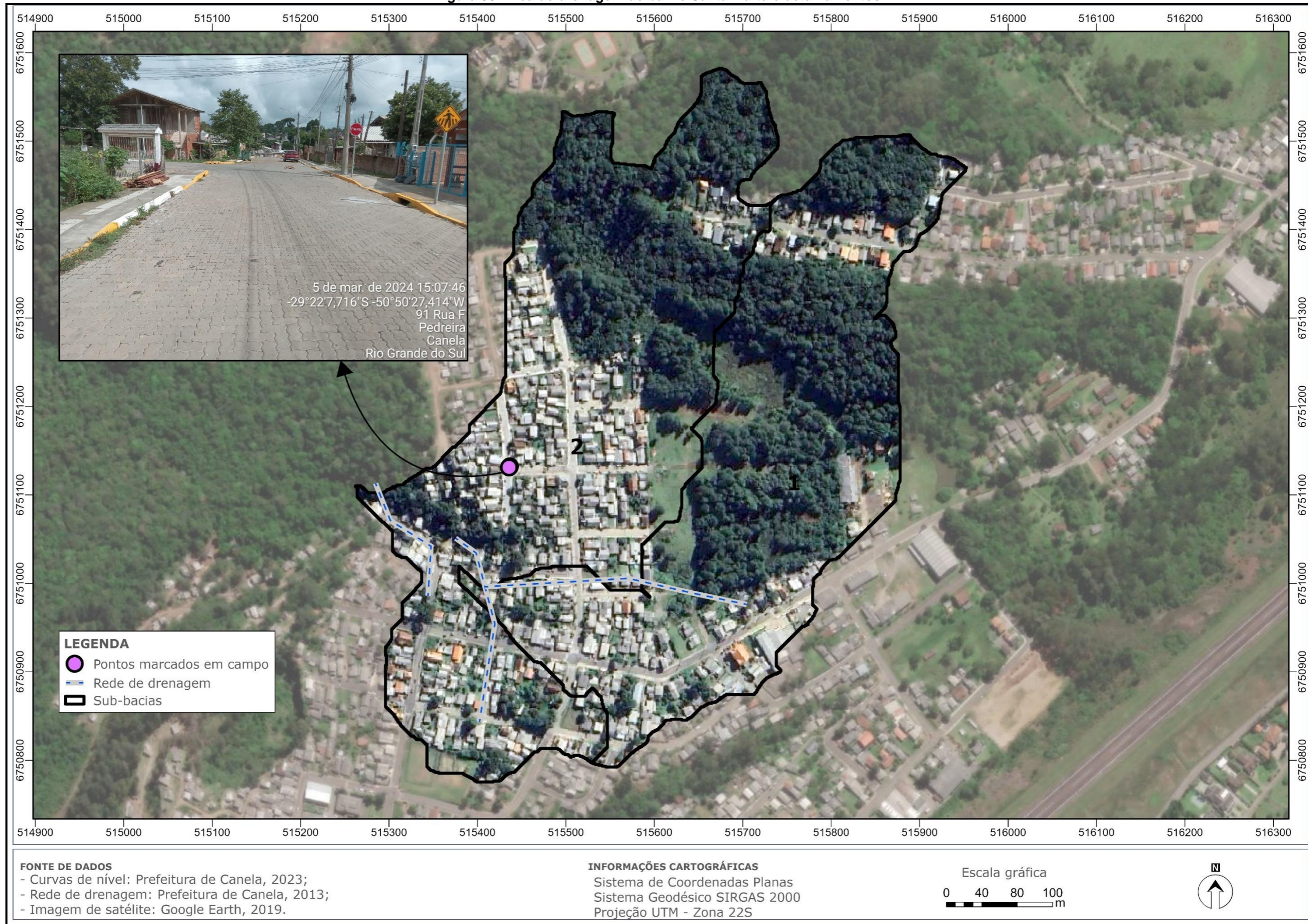
Figura 30. Área de drenagem do bairro Santa Marta e detalhes.
