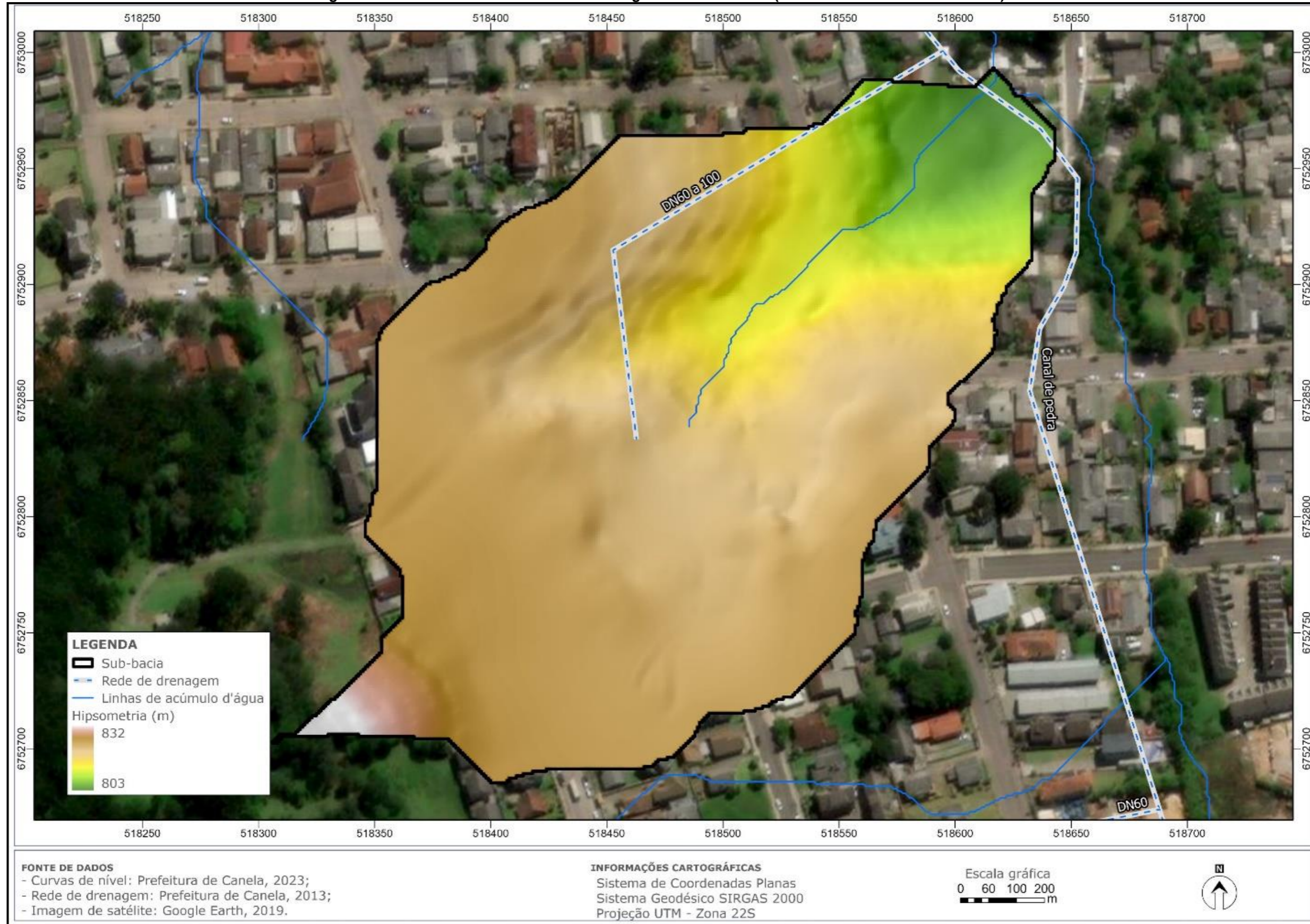
Figura 48. Microbacias e linhas de acúmulo d'água no bairro Boeira (rua Bernardino Timóteo Fonseca).
