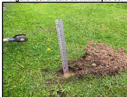
Figura 133. Ensaio de infiltração 08.
