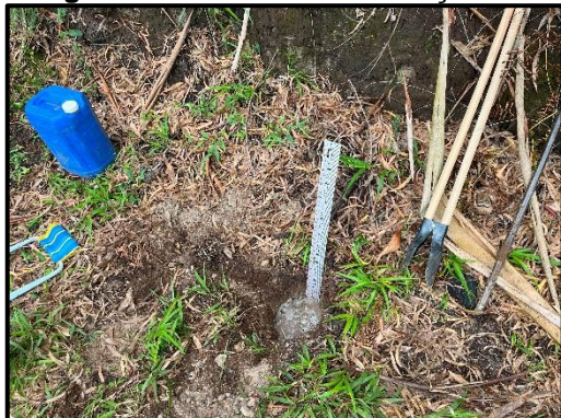
Figura 120. Ensaio de infiltração 02.
