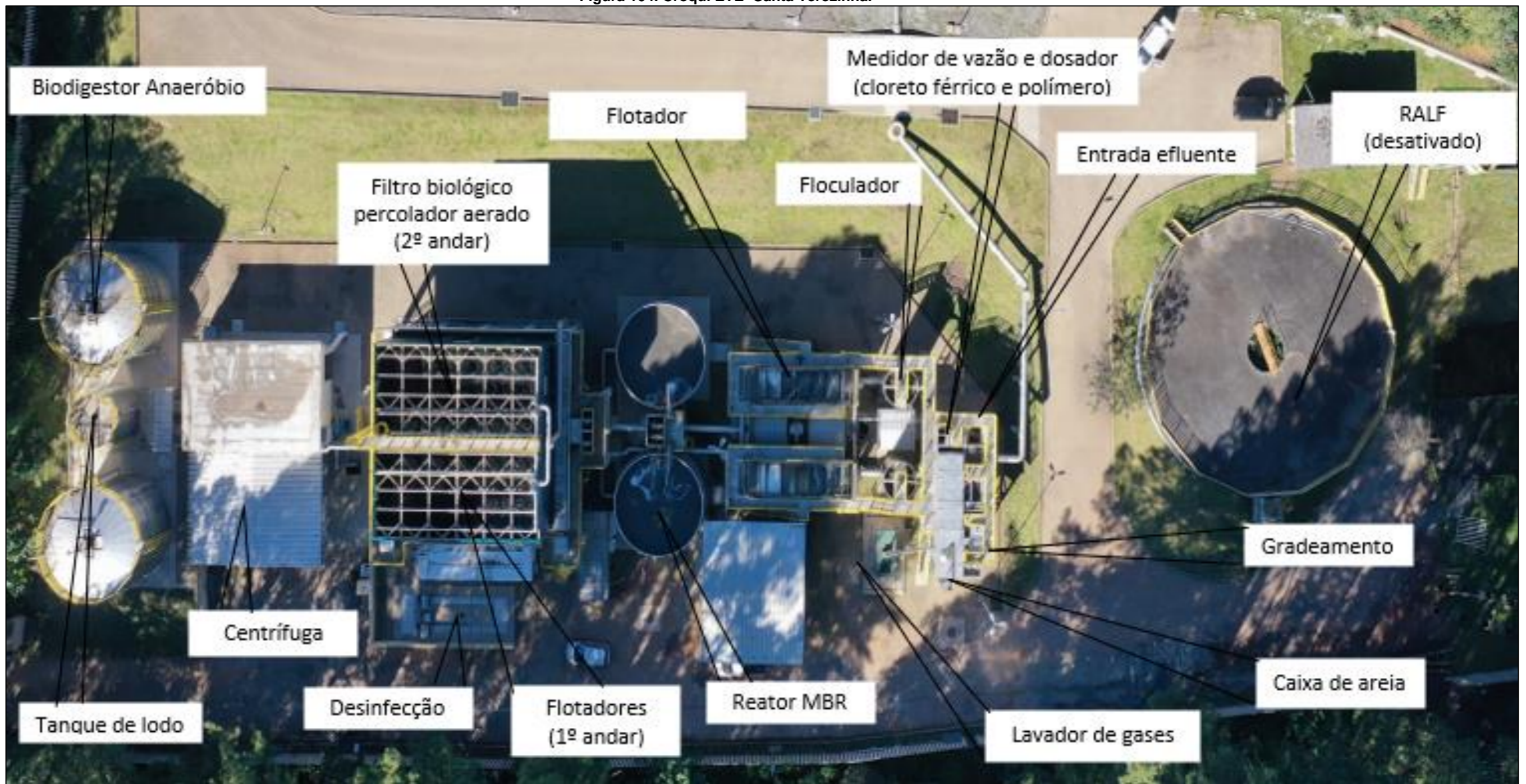
Figura 104. Croqui ETE- Santa Terezinha.
