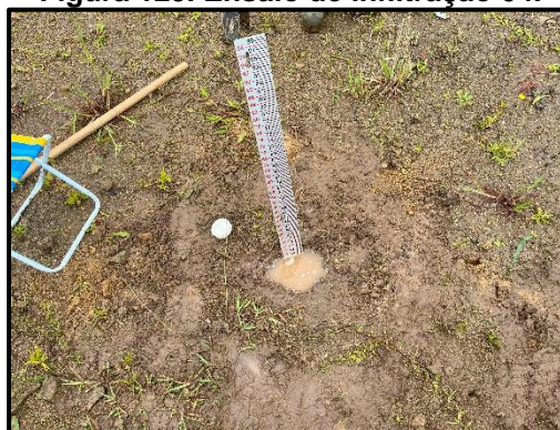
Figura 125. Ensaio de infiltração 04.
