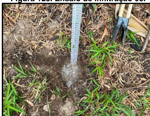
Figura 123. Ensaio de infiltração 03.
