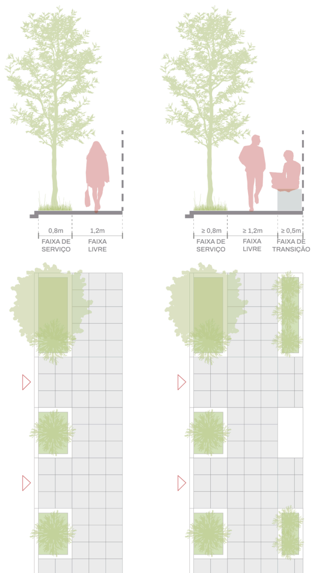
Fig. 1.29. Dimensionamento de calçadas (tipo I) Fonte: Elaboração própria.
