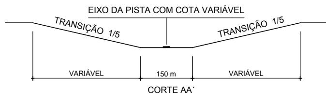
AS ÁREAS DE TRANSIÇÃO INCIAM NAS BORDAS DA FAIXA DE PISTA, COM ALTURA DO EIXO DA PISTA NO PONTO MAIS PRÓXIMO E SE DESENVOLVEM EM RAMPA 1:5 ATÉ 45m DE ALTURA EM RELAÇÃO AO PONTO MAIS ELEVADO DO EIXO DA PISTA (ELEVAÇÃO DO AERÓDROMO) TEM POR ISSO LARGURA VARIÁVEL DE ACORDO COM A ALTURA DO EIXO DA PISTA EM CADA PONTO DO SEU DESENVOLVIMENTO.
